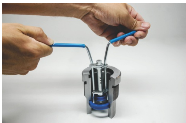
5) Posicionando a gaxeta dentro do alojamento e retirando o alicate
