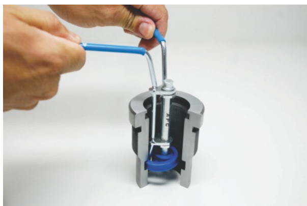
4) Instalando a gaxeta dentro da guia do cilindro
