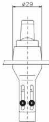
FURAÇÃO P/ PAINEL VÁLVULA M5 BOTÃO COGUMELO
